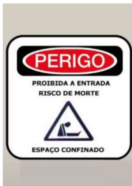
Figura 10 – Sinalização para identificação de espaço confinado Fonte: NR-33 (2012)
